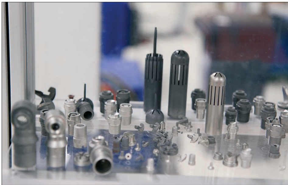
Edelstahl-Düsen: Die dunklen Bauteile sind die größeren Zwischenprodukte, die helleren die fertig „geschrumpften“ Düsen.
