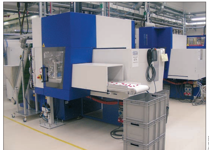
Einer der 23 Spritzgussroboter, in dem Agrar-Düsen hergestellt werden.
