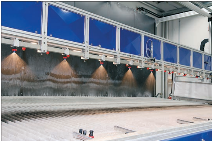
Lechler prüft in verschiedenen Versuchsständen die Funktion der Düsen, hier z.B. ein Versuchsstand für Agrar-Düsen.
